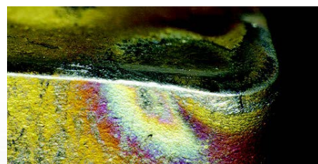
高い切削熱による塑性変形
