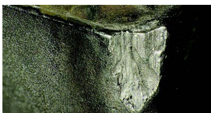
溶着チッピングを起因とした欠損
